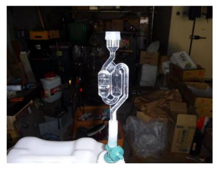
酵母をネット通販で購入した時に、ついでにS字型発酵栓も買いました。栓という名の通り、空気と反応容器とを遮蔽するためのものだと思っていましたが、発酵している時はここを炭酸ガスが通るので、ぶくぶくと気泡が出ます。気泡が出ている間は発酵が続いているという目安にもなるんじゃないと思います。(専門家ではないので不詳)
