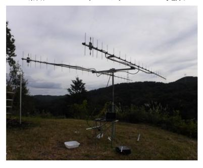
先日から製作していた 430MHz 帯用 24 エレハ木アンテナを、垂直偏波2スタック構成にして完成させました。
