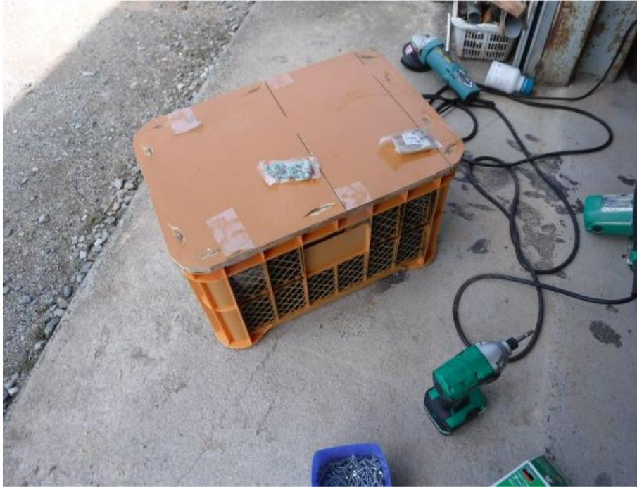
コンテナの蓋の部分に扉を付けるために、ヒンジ(丁番)と掛金を取り付けます。この時、コンパネを3つの部分に切断してしまわないで、切れ目を入れて、少しの部分で接続したままにしておきました。この状態で丁番と掛金をねじ止めしました。コンパネで作った蓋をコンテナにコーススレッド(木ネジ)で取り付けた後で、手鋸を使って接続部を切断しました。
