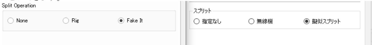
それは、無線機(radio)タブでスプリットの項を、上の図に示すように、「疑似スプリット」または「Fake It」に設定することです。この設定により、WSJT-X や JTDX は、副搬送波を 1.5kHz～2kHz の範囲に設定して、かつ CAT で無線機の周波数を制御することにより、目的の周波数で送信してくれます。この結果、仮にオーディオ信号に第 2 次以上の高調波があったとしても完全に SSB の帯域外なので電波として発射されることがなくなるからです。
