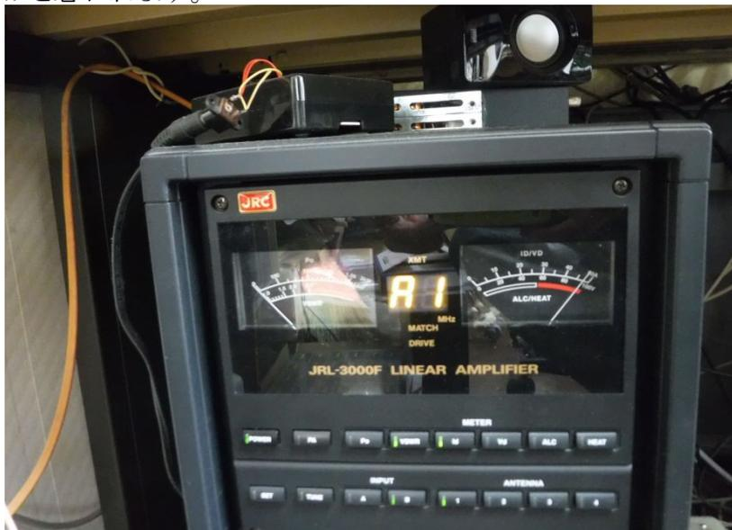
このリニアアンプの取扱説明書によれば、ファイナルは 2SK410×16 個となっていて、回路図を見ると 4 個の 2SK410 による増幅回路 (250W 出力) が 2 組搭載された基板が 2 枚あって、4 合成されて 1kW を得ているようです。つまり、同じ回路が 4 回路あるので、そのうちのどれか 1 つでもショート状態になっていれば、今回のような症状になると考えられます。壊れた回路だけを切り離せば、3/4 の出力が得られるかもしれません。
