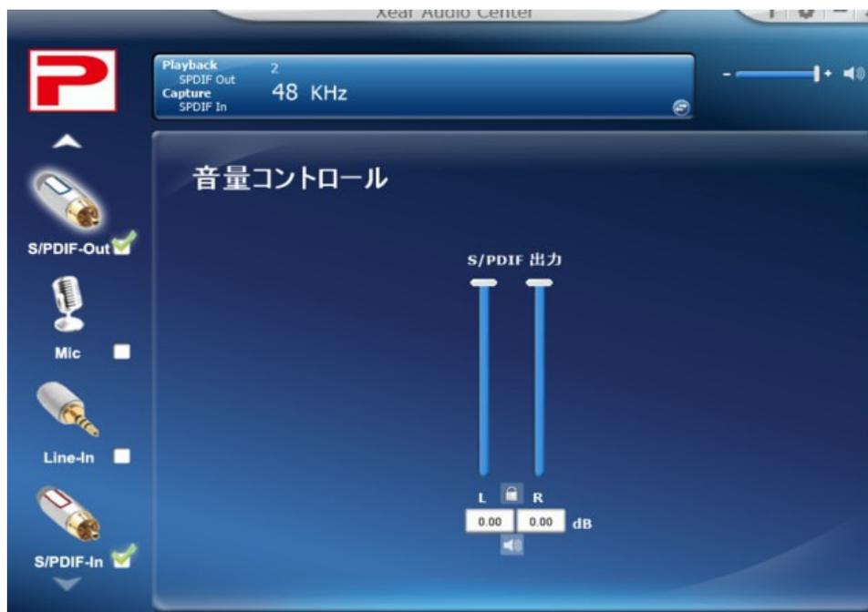
このUSB S/PDIFには、C-Mediaという台湾メーカのCM6206というICが使用されているようです。多分、CM6206では、3つの出力(Speakers, Headphone, S/PDIF)のうちの選択された一つだけに出力されるようになっているのでしょう。出力なので、同時に全部に出力してもよさそうなものですがね。
