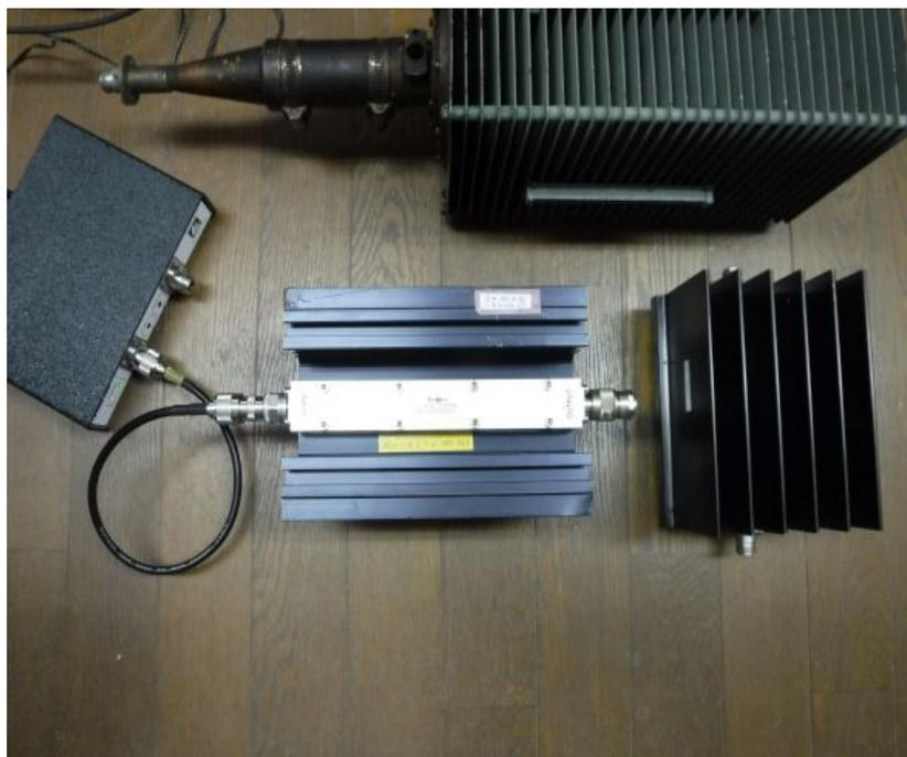
写真上側のダミーロードが HF 帯として使用してきたモノで、東京電波・昭和 40 年製造・定格不詳。右下のモノが、Bird 製 300WA-FFN-30 で 300W 30dB のアッテネータ。写真中央のモノが、知人から借りてきた DICONEX 製の 250W 30dB のアッテネータです。DICONEX の 250W の方が Bird 製の 300W よりも放熱面積が大きそうですので、実力は
