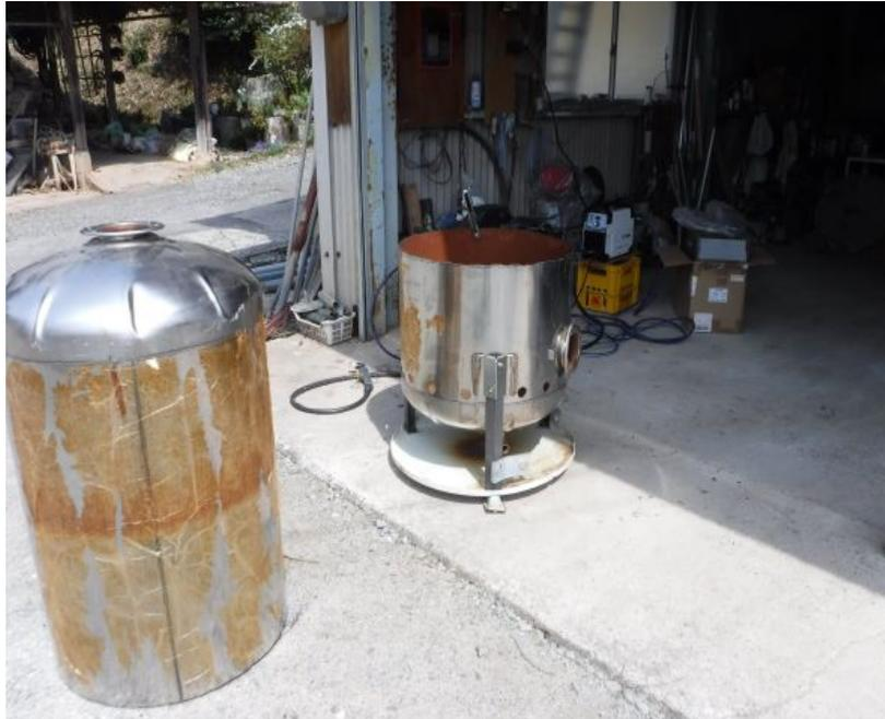
上の部分は安定のためにコンクリートブロックを3個置いて、その上に設置しました。仮に我が家の裏庭に設置してみました。電気温水器の上端部の板金は、蓋として利用できそうです。
