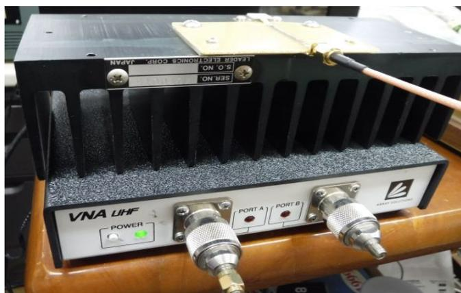
抵抗器はヒートシンクにビス止めしましたが、間に銅箔テープを挟み込んで、PCBの銅箔と半田付けしています。（製作時には、先にPCBと銅箔テープを半田付けして、それを挟み込んでビス止めしました。）VNAuhfを使って1MHz~1200MHzの周波数特性を測定しました。SWRは1.25以下に収まっていますので、430MHzまでのハムバンドでダミーロードとして使うには十分実用になると思います。
