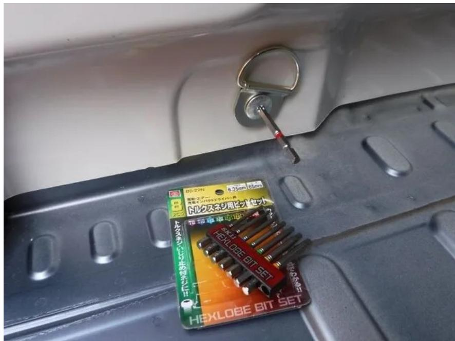
先日 Amazon で注文していたトルクスネジ用ビットが届いたので、早速、隔壁の撤去作業をしました。一番大きなビットが丁度適合しました。トルクスネジで荷物を固定するフックが 2 個取り付けられていました。後は、M10 のボルトが 1 本と M8 のボルトが 15 本でした。
