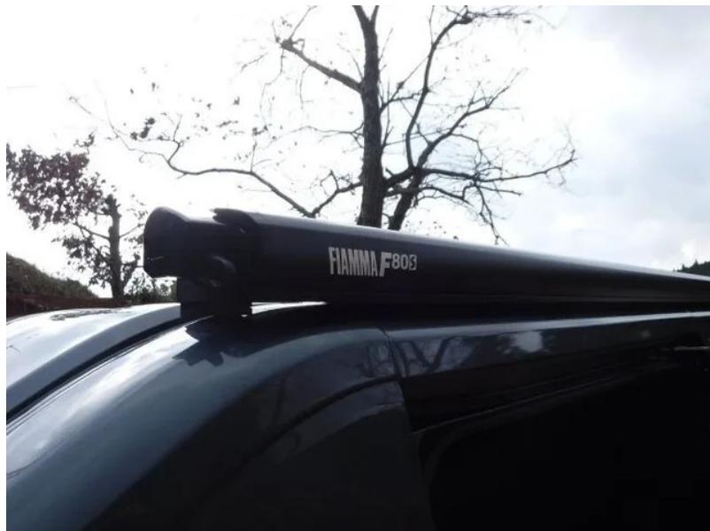
モデル名は、Fiamma の F80S Ducato 320 というルーフオーニングにしました。ハイエースの時には、F45S 340 というサイドオーニングを取付けました。ハイエースのスーパー長には丁度良いサイズだったので、オーニングを広げている時、雨が隙間から吹き込むので、雨が降る時には、水道パイプの保温材で応急処置的に隙間を埋めました。サイドオーニングというのは、壁に取り付けるものなので、どうしても隙間ができてしまいます。そこで、雨の吹き込みを避けるために、ルーフオーニングという天井付けのオーニングにしたのです。
