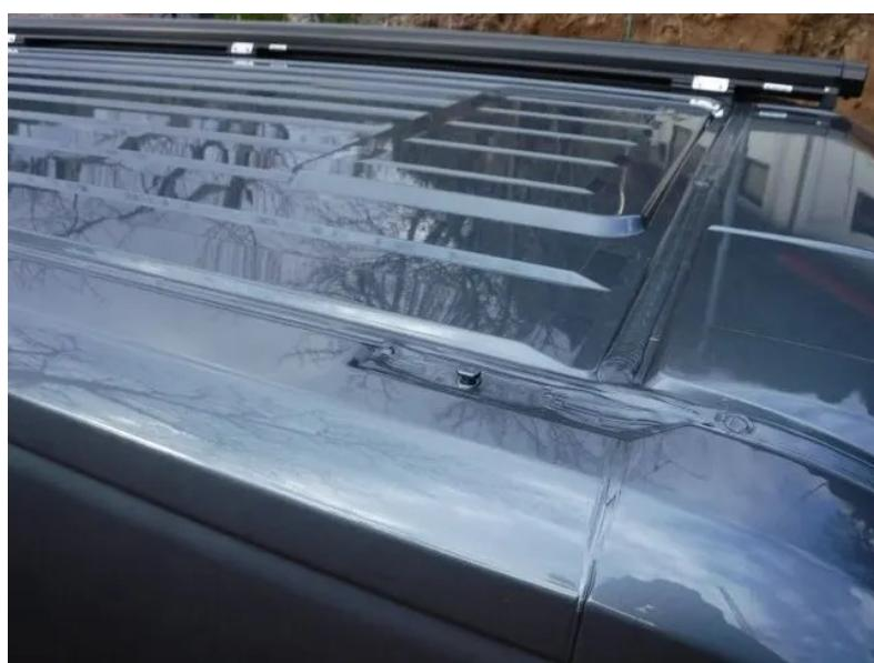
思った通りに隙間ができるないかどうか確認したところ、バッカリOKでした。F80S Ducato 320 というモデル名が示す通り Ducato 専用のアタッチメントが付属していることです。自分で取り付けていないので、どうなっているのか詳細は不詳ですが、屋根に穴を明けることなく、Ducato の屋根に出ていている釘の頭のような金具を利用して取付られています。サイドオーニングは、大抵の場合、壁や屋根に穴を明けてボルトでアタッチメントを取付けるようになっています。ハイエースの時には、自分で穴明けしました。幸い、その部分から水漏れすることはありませんでしたが、新車に穴を明けるのは一寸度胸が要ります。
