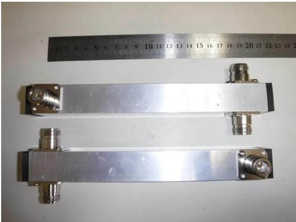
内部導体を中心に保持するために、3D プリンターでセパレーターを製作しました。また、防水のために、アルミ角パイプの両端に差し込むエンドキャップも 3D プリンターで製作しました。
