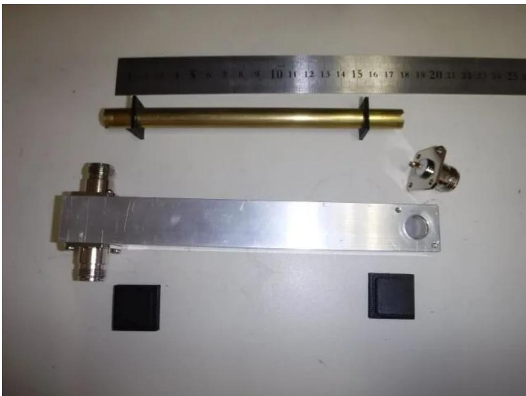
内部導体として長さ 173mm の 12φ 真鍮丸パイプ 1mm 厚を使用します。内部導体の接触部分はコネクタの端子と干渉しない程度にヤスリがけしました。N型コネクタの取付穴は  $\phi 2.5$  の穴を 1 つのコネクタに付き 2ヶ所明けて、M3 タップをたてました。2ヶ所でも穴が合わずには苦労するので、4つなんて無理です。
