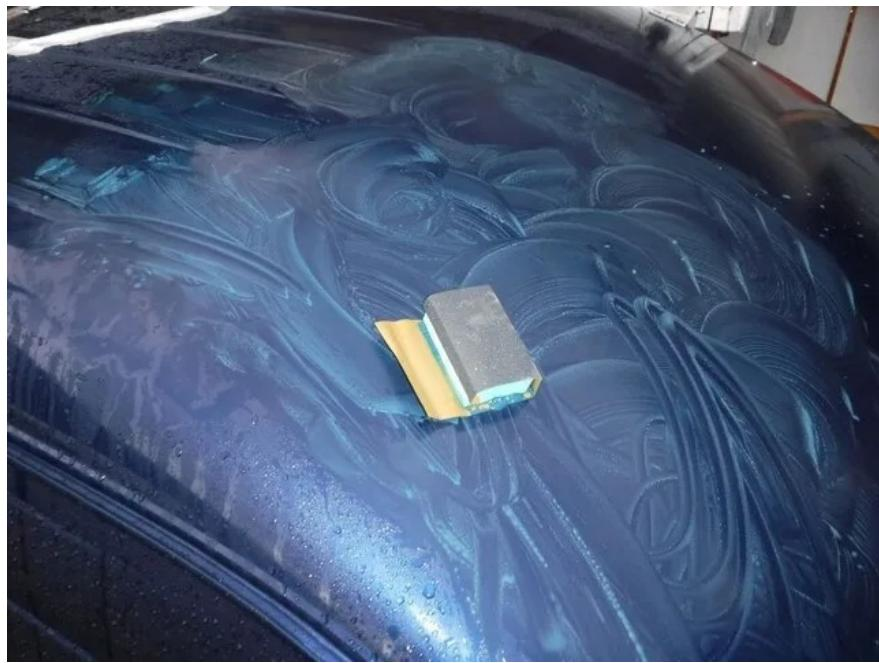
サンドペーパーで磨いたまま放置するとサビてしまう心配があるので、早めに塗装しなければなりません。今朝6時半頃からブドウ園で防除作業をした後、薬液が乾いて袋掛けができるようなるまでの間に塗装作業をしました。
