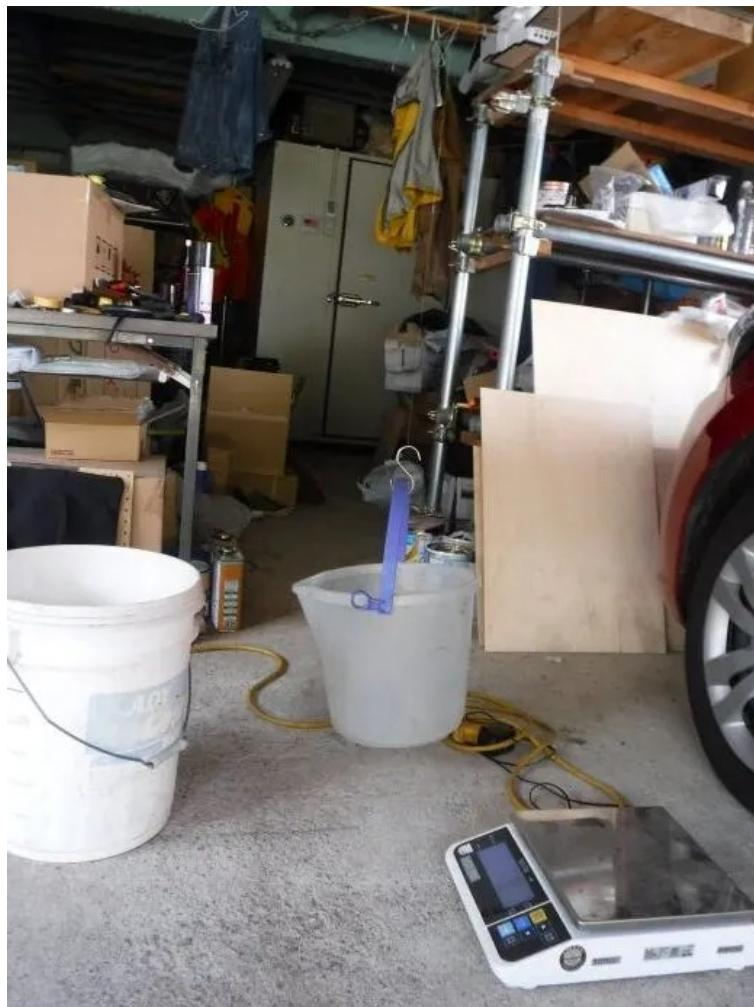
写真に示すように、車庫の天井からバケツを吊るして、バケツに少しづつ水を入れていき、切れたたらバケツごと秤に乗せて重量を測定するという方法で実験しました。
