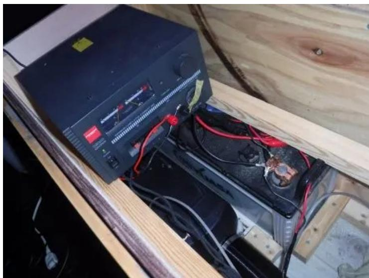
FFヒータは、起動時にディーゼルエンジンにつきもののグローで加熱して燃焼を促進させる仕組みになっています。このため、起動時には約 10A の電流が流れていきました。ちなみに、電圧は 13.8V なので、138W です。これでは、100W 定格のスイッチング電源の出力電圧が低下するのは当然です。グローが暖まって、通常運転モードに入ると、ファンと燃料ポンプが電力を消費しますが、この時の消費電流は 1A 程度です。
