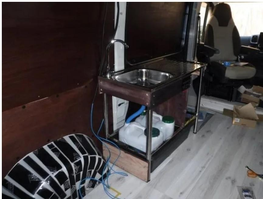
流し台を車内に配置してみました。写真では分かりにくいのですが、流し台の中央あたりにルームライトやポンプなどのスイッチパネルを取付ました。シンクの下に排水タンク（手前）と給水タンクを配置しました。移動中に水が漏れることがあるので、これらのタンクをト口箱に入っています。漏れないまでも、タンクに結露することもあるので、ハイエースでの経験から改善しました。
