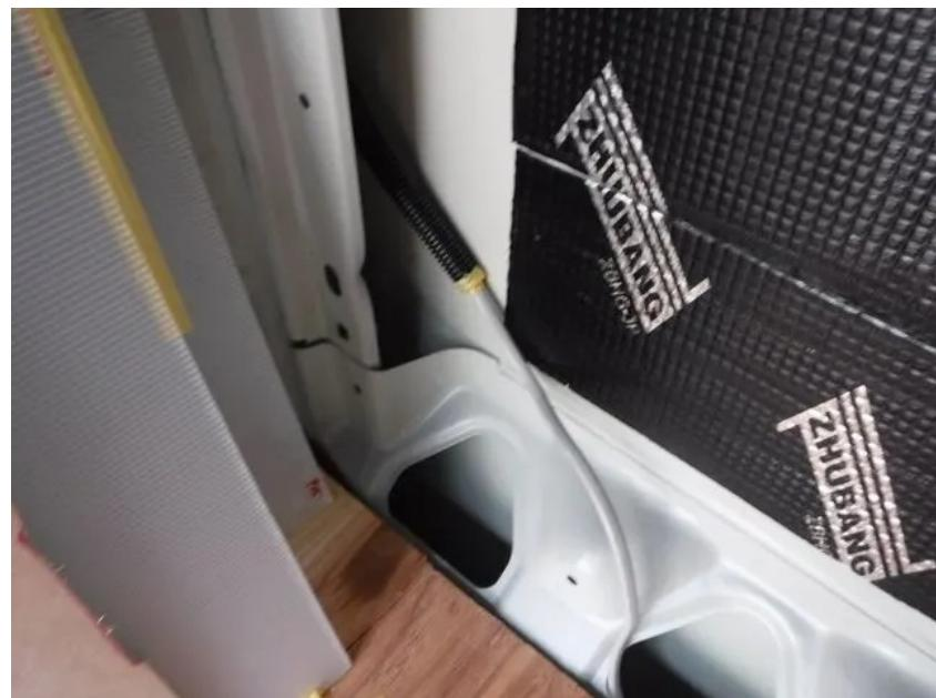
内張りの一部を塗装しました。内張りには、厚さ 4mm のベニヤ（ラワン材）を使いました。型取りした PP ボードから形を写して切断・穴明けします。もう一度現物に合わせて、形がピッタリ合うことを確認した後に、サンドペーパー (#240) で仕上げます。これに、油性のオイルステイン（マホガニー色）を先に塗って、乾燥後に水性のウレタンニス（艶消し）で仕上げました。ウレタンニスを塗るときには、コテバケという道具を使いました。刷毛目が出ず、刷毛の毛が抜けたりすることもなく、良い感じに仕上がりました。コテバケは、元々、クロスを貼る時に糊を塗るための道具だそうです。初めてコテバケという道具を使いました。
