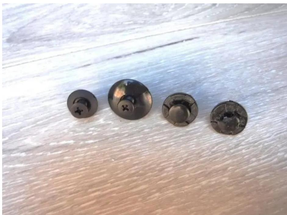
右の2つはAmazonで購入したもので、右端のモノは頭が欠損しています。リベットの頭が欠損する理由は、強い力が掛かっていて抜けにくい状態なのに、無理やりマイナスドライバーで捻ったからです。合板の穴位置と鉄板の穴位置がちゃんと一致していないと、リベットをプッシュすることさえできません。これを避けるには、合板の穴を多少大きめに開けてやれば良いと気づきました。また、合板と鉄板が隙間なく接している必要があります。
