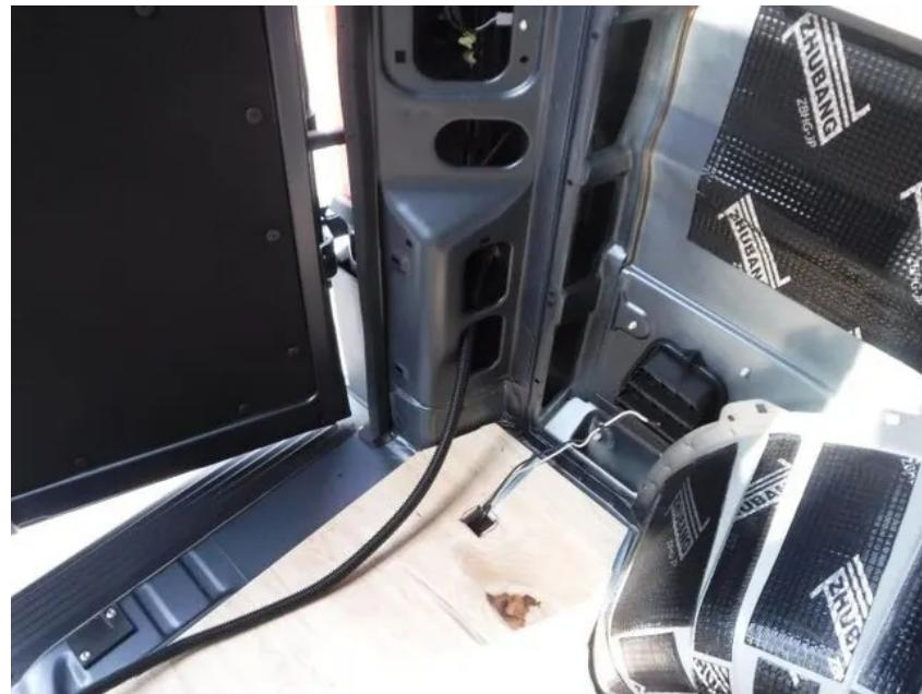
車の左最後部にはポータブル電源を置き、運転席の後ろの壁面にコンセントを設置したいので、床下を通すか屋根に近いところを通すかの2択ですが、床には断熱材を敷いてるので、やはり天井に近いところを通しました。車の屋根に近い場所を通すので、熱のことがちょっと心配だったので、コルゲートチューブで保護しました。10mで何とか足りそうだと思っていましたが、ほぼ使い切りました。内径13.2mmのコルゲートチューブにVVF1.6-2Cはギリギリのサイズなので、次の手順で作業しました。1)コルゲートチューブにΦ1.0mm位の針金を押し込んで入れる。2)針金をパイロットワイヤとして、広い場所でVVFケーブルを入線する。3)VVF入りのコルゲートチューブをDUCATOの壁面などの配線可能な場所を通す。
