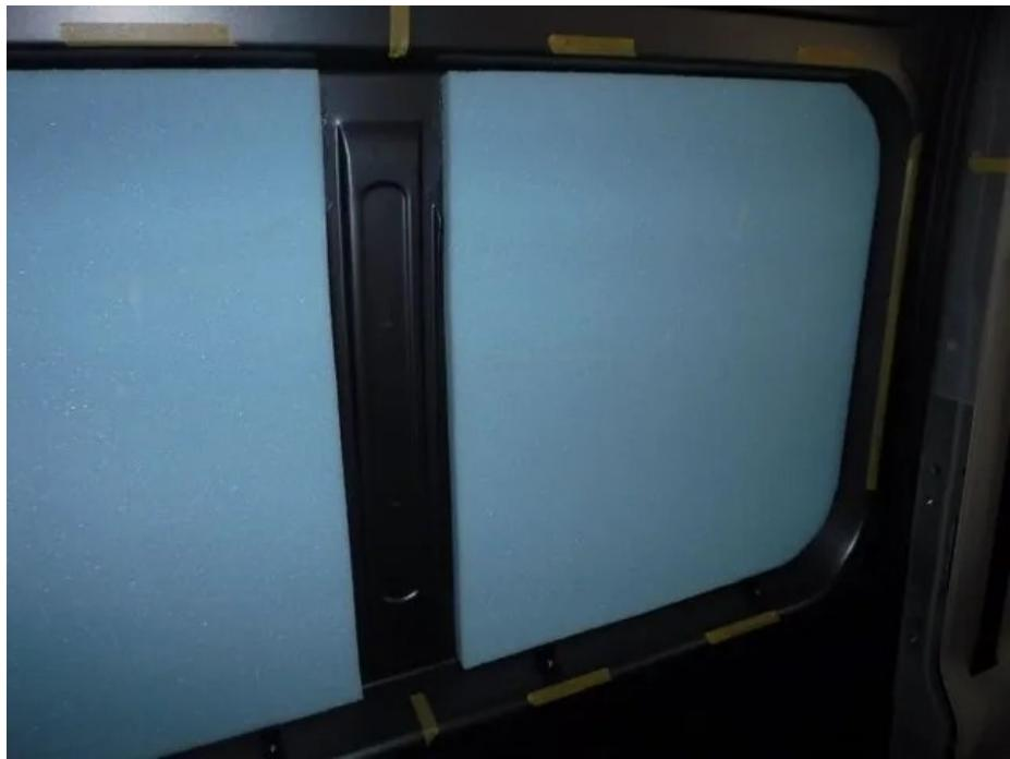
スタイロフォームがむき出しのままだと「保安基準」に抵触するので、その上に4mm厚のベニア板を内張りとして被せるですが、適当な取付穴などはありません。仕方なくドリルで穴を明けてビスで固定するのですが、そのための押え板のような部品を3Dプリンターで製作しました。爪のようなもので合板を押えて、スライドドアの窓枠にビスで固定します。上と下と横とでは夫々寸法や角度が違うので、別々のものを製作しました。写真の合板は未塗装の状態です。此処の処寒い日が続いているため、塗装作業を控えています。塗装すれば、もう少し落ち着いた色になる予定です。
