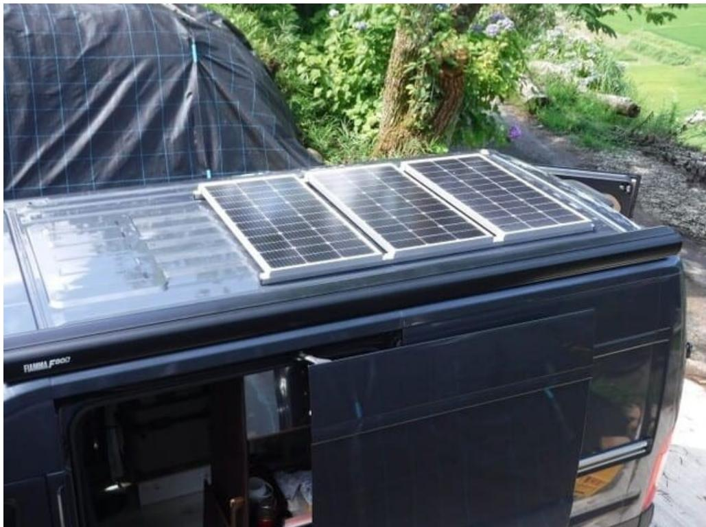
屋根に取り付けたレール（アルミ角パイプ）には予め取り付け用の穴にはM6ネジが切ってあるので、2時間程で取り付け完了しました。現物合わせでソーラーパネル側のアルミフレームに3.4mmの穴を明けて、M4のタップを立てました。
