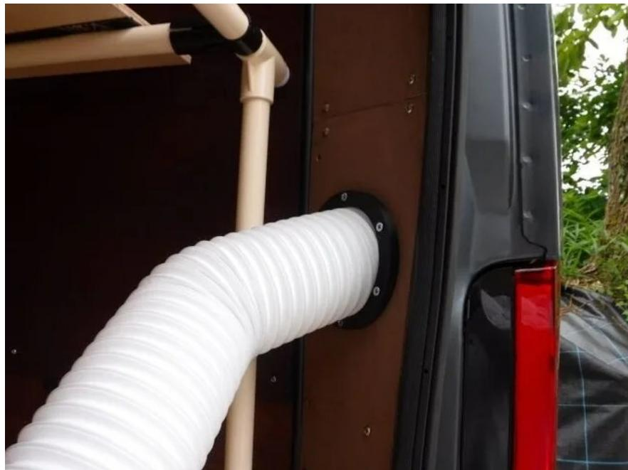
モバイルクーラー本体は一方に寄せて配置したかったのですが、吸気および排気用ダクトの長さがギリギリだったので、真ん中に配置せざるをえませんでした。
