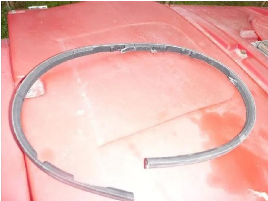
交換用にVベルトを注文したいのですが、サイズが不明なので困っています。相当に摩耗していて、いつ切れてもおかしくない状態です。こんな状態なので、サイズを示す表示を読み取ることはできません。かろうじて、BANDO RED らしき表示が見えますが、肝心のサイズの部分が不明です。幅は実測で15mmでしたので、B形だと思われます。外周側の寸法を測ったところ、950mm位でした。ネットやYoutubeなどを観ると、切ったVベルトの長さを計って、インチに換算した寸法が良いとのこと。この方法で計算すると、 $950/25.4=37.4$  となり、B37が良いということになります。
