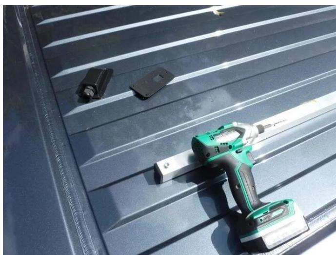
取敢えず、洗車はできたので、ソーラーパネルを取り付ける前に配線口を取り付けました。この配線口（ケーブルエントリーグランド）は 2 個入りでしたが、手持ちのケーブル（CV-3C 2.5SQ）が丁度入るので、雨漏りのリスクを下げるために 1 個だけ使いました。配線口は、紫外線による劣化を軽減するために、ソーラーパネルの下に配置しました。配
