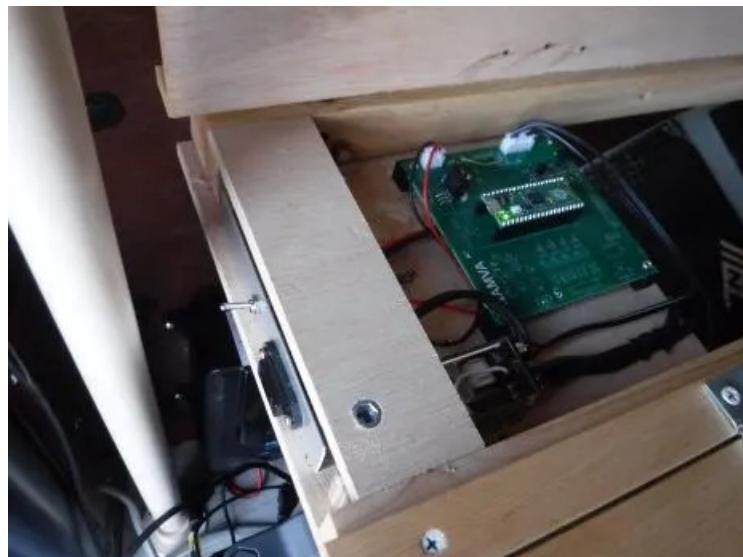
車載用リチウム電池放電コントローラは、リチウム電池の過放電を予防し、ポタ電をバックアップとして、車載冷蔵庫に AC100 を供給し続けるために製作しました。このコントローラは次のように動作します。
