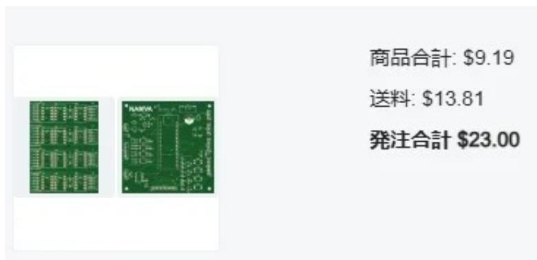
さて、2度目の発注内容ですが、基板の製作費よりも送料の方が高いので、2つの作品をまとめて注文しました。1つは、以前ブログで紹介したラズパイ pico で色々製作できるようにと設計した多目的ボードです。もう一つは、ローテーターをリモートコントロールするためのインターフェース基板です。こちらのボードは、1枚の大きさが 60x20mm と小さいので、4つを1枚のボードに面付けしました。Vカットの指示がちゃんと通るかどうか多少不安ですが、試してみました。代金は、基板5枚づつ両方併せて23ドルでした。前者の基板は4層 100x100mm で 7.15 ドル、後者の基板は2層 60x80mm で 2.04 ドルという内訳です。
