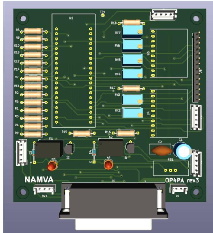
知り合いの方からJLCPCBという中国のPCBメーカーに発注すれば、凄く安くPCBが製作できるという話を聞いて、たとえワンオフの自分用だけのものでも、下手にエッチングしたりCNCで加工するよりも手堅く良いものができるようなので、発注すること前提で設計しました。
