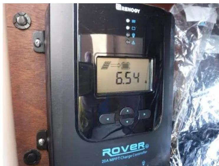
上の写真のとおり、6.54Aで充電できていました。300Wのソーラーパネルがキャンピングカーの屋根に付いていますが、この時の太陽高度は22°でした。 $\sin(22^\circ)=0.37$ なので、この条件では、いくら頑張って発電しても  $300 \times 0.37 = 111\text{W}$  です。この時のバッテリー電圧は13.4Vだったことから、効率100%だとすれば充電電流は8.28Amaxなので、そこそこ計算と一致していることが分かります。
