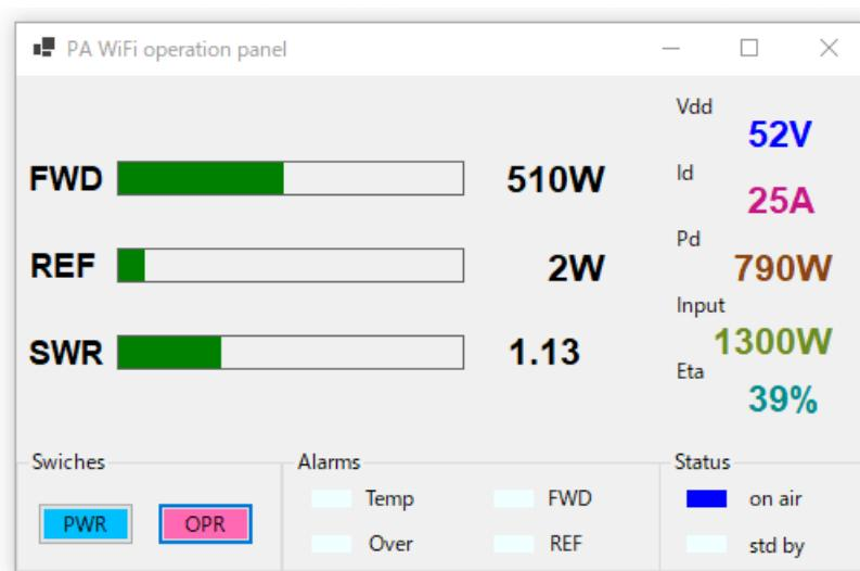
パソコンとラズパイ picoW とは UDP を使って通信しており、パソコンから定周期にポーリングしてデータを吸い上げています。UDP は TCP と違ってコネクションレスなので、シリアルポートのように好きな時にメッセージを送ることができて待ち合わせをする必要がなく、遅延が小さいためリアルタイム性に秀でています。パソコン側のアプリは VB.NET で開発しました。
